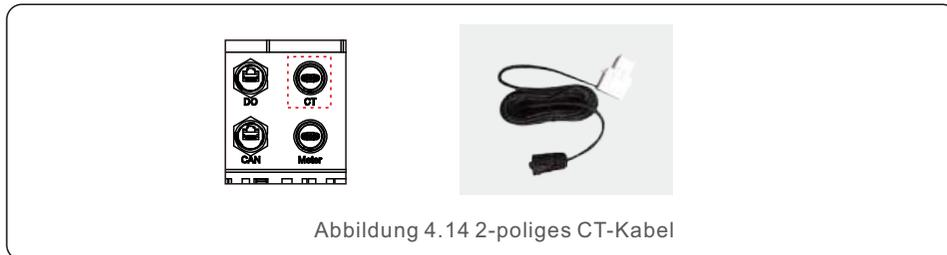
Abbildung 4.14 2-poliges CT-Kabel
